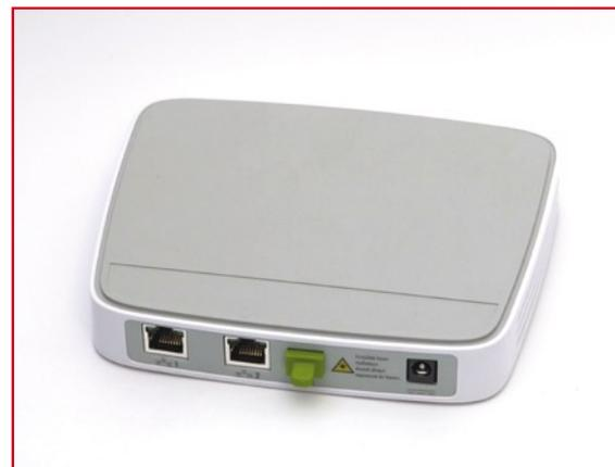
Insérez l'embout de la fibre optique, provenant de votre prise optique murale, dans la prise PON ainsi dégagée jusqu'à entendre un "clic" de verrouillage.
