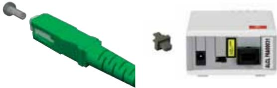
Insérez l'embout de la fibre optique, provenant de votre prise optique murale, dans la prise PON jusqu'à entendre deux "clics" de verrouillage. Ne le dirigez pas vers vos yeux au risque de vous brûler. Assurez-vous que l'embout soit bien bloqué.
