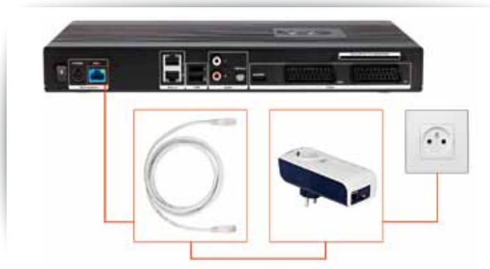
> **Reliez le Décodeur TV à la prise électrique avec un autre adaptateur CPL\*** : reliez le câble électrique à l'alimentation et l'adaptateur CPL à la prise électrique.
