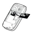
5/ Réinsérez la batterie et la trappe arrière.
