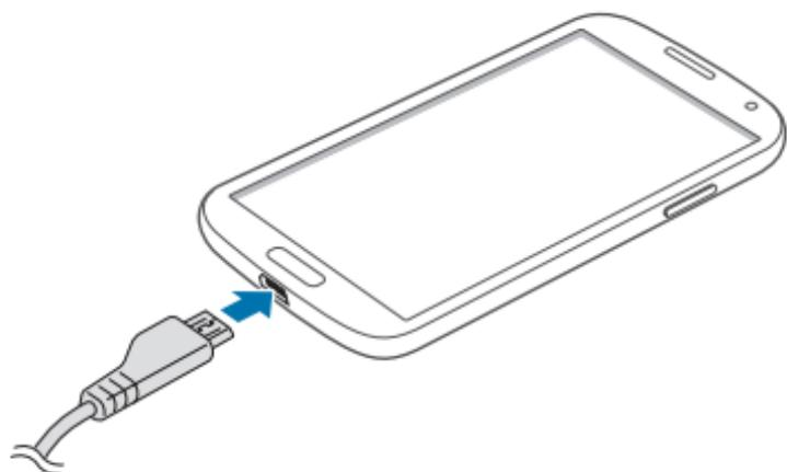
**Branchez la fiche micro-USB du chargeur sur le connecteur du téléphone et branchez l'autre extrémité du chargeur sur une prise de courant.**
