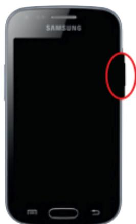
Maintenez la touche de mise sous tension (côté droit) enfoncée jusqu'à ce que le mobile s'allume.
