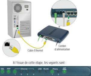
Raccordez votre modem à l'ordinateur. Pour cela, branchez le câble Ethernet comme illustré ci-dessus, puis cliquez sur le bouton "OK". Passez ensuite directement à l'étape 6 de ce guide. Dans notre exemple, le voyant Ethernet 1 est allumé car le câble Ethernet est branché sur le port Ethernet n°1 du modem. Attention : Vous ne devez en aucun cas raccorder simultanément le câble Ethernet et le câble USB.
