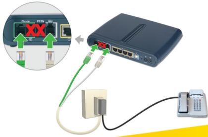
Raccordez le câble téléphonique/ADSL au modem (le câble vert sur la prise Phone 1, et le câble gris sur la prise DSL). Branchez l'autre extrémité du câble sur une prise téléphonique murale (elle doit être placée en premier). Branchez ensuite un téléphone sur cette même prise.
