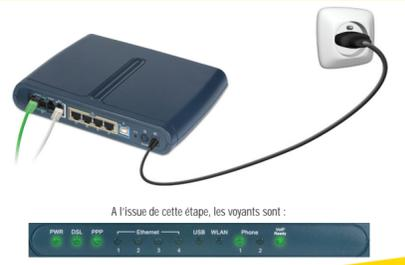
Raccordez le cordon électrique noir entre votre TELE2 Box et une prise électrique, puis appuyez sur l'interrupteur "ON" du modem. Attendez que les voyants du modem soient allumés comme décrit ci-dessus, et notamment que la diode "VoIP ready" reste verte pendant plus de 10 secondes.
