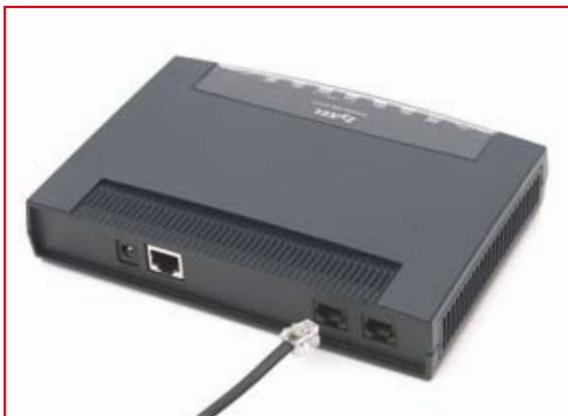
Raccordez le **câble Ethernet** fourni dans le port **LAN 10/100M** du **modem VDSL**.
