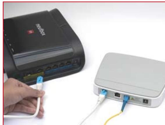
Procédez au **raccordement électrique** du boîtier **ONT** grâce au câble d'alimentation fourni.
