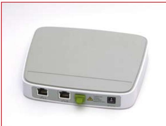
**Insérez l'embout de la fibre optique**, provenant de  **votre prise optique murale**, dans la prise **PON** ainsi dégagée jusqu'à entendre un "clic" de verrouillage. Assurez-vous que l'embout soit bien bloqué.
