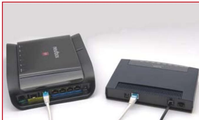
Procédez au **raccordement électrique** du modem VDSL grâce au câble d'alimentation fourni.
