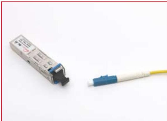
Insérez l'**embout bleu** de la fibre optique dans le module **SFP**, du côté de la poignée bleue.
